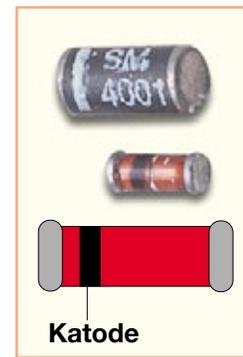
**Bild 6:** Standard bei Universaldioden - das MELF-Gehäuse
