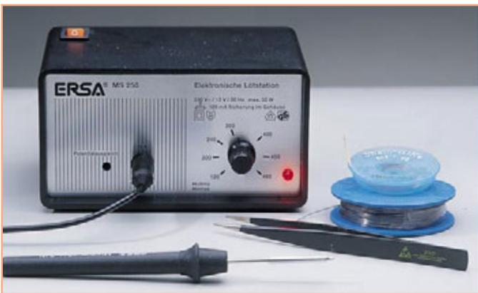
**Bild 14: Die Grundausrüstung für das Bestücken von SMD-Bauteilen**
